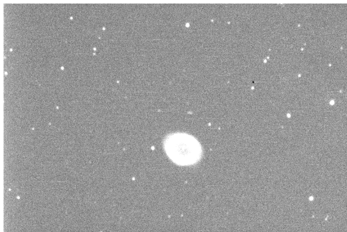
Abbildung 2: Aufnahme nach Abzug von Darkframe und Flatfield
